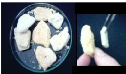
Figura 3. Material plástico tratado com ácido nítrico concentrado (esquerda); comparação entre a espessura do plástico tratado com ácido nítrico concentrado (~6mm) e do sem tratamento (~3mm) (direita).
